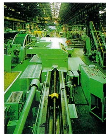
管圧延機 Cold pilger mill
