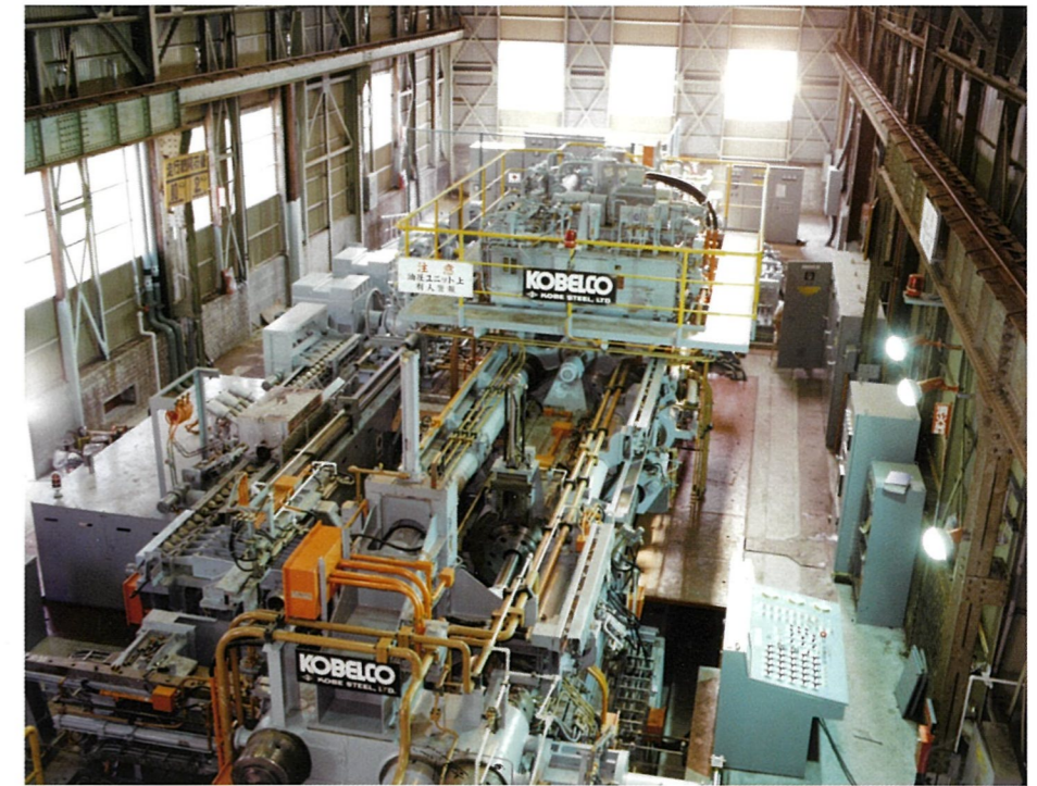
■製造設備／熱間静水圧押出プレス Hot isostatic extrusion press
